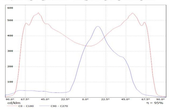
Luminaire: LEDiL Oy C16181\_STRADA-2X2-ME-N\_(QUICK\_FLUX\_XTP\_2x4\_740\_LS\_G5) Lamps: 1 x QUICK\_FLUX\_XTP\_2x4\_740\_LS\_G5\_969.2Im@250mA\_P=5.68795W\_I=0.25A
