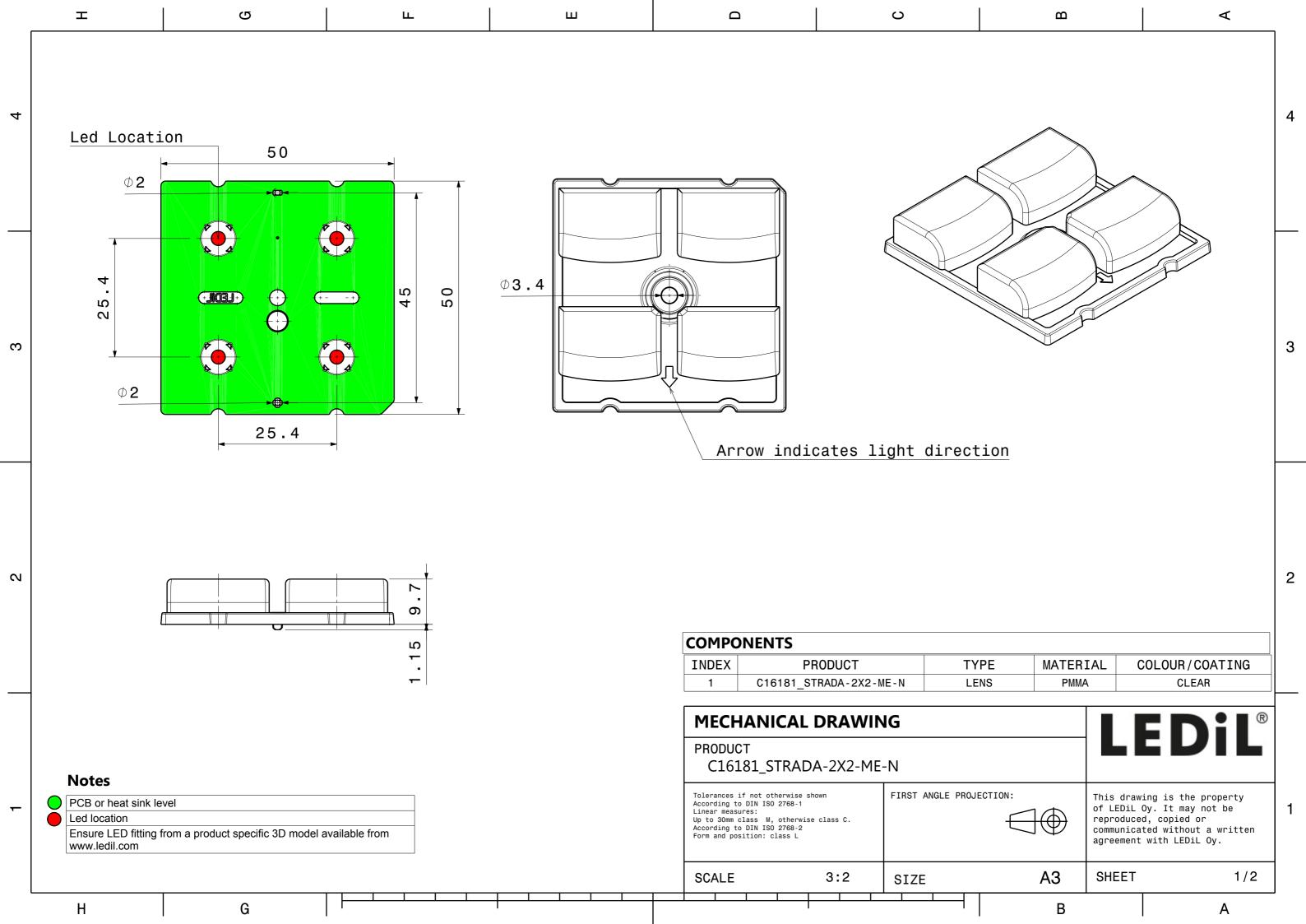
Luminaire: LEDiL Oy C16181\_STRADA-2X2-ME-N\_(QUICK\_FLUX\_XTP\_2x4\_740\_LS\_G5) Lamps: 1 x QUICK\_FLUX\_XTP\_2x4\_740\_LS\_G5\_969.2lm@250mA\_P=5.68795W\_I=0.25A
