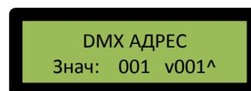
**Примечание.** При нажатии кнопку «**OK**» для записи нового адреса происходит последовательное выполнение операций записи, считывания и сравнения адресов. Таким образом, сообщение «**Адрес изменен!**» гарантирует фактическую перезапись адреса DMX. Повторное считывание адреса для проверки правильности операции можно не выполнять.
