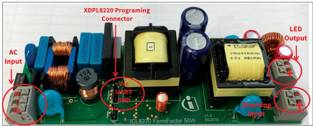
Рис. 11. Отладочная плата для контроллера XDPL8220 с конфигурацией светодиодного драйвера на 50 Вт
